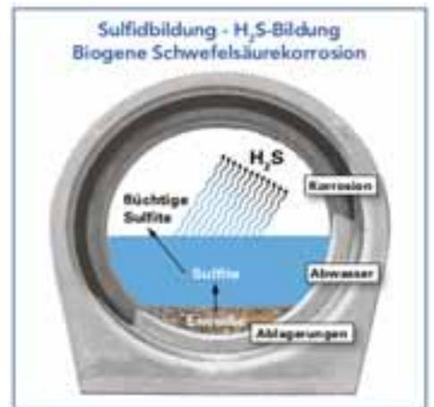
Schematische Darstellung, wie Faulgas die Kanäle angreift.
