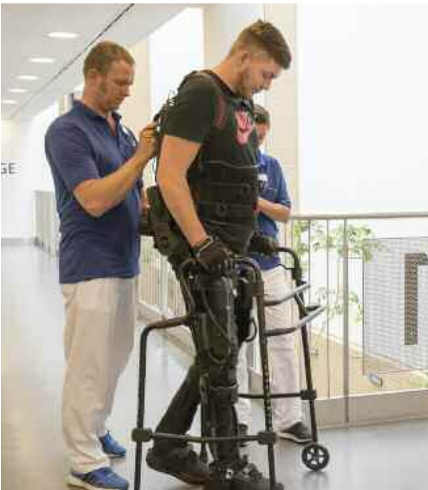
Eine besondere Therapiestunde: Johannes Liesecke im sogenannten Exoskelett. Computertechnik, Sensoren und eine äußere Stützstruktur machen es ihm möglich, aufrecht zu gehen.
